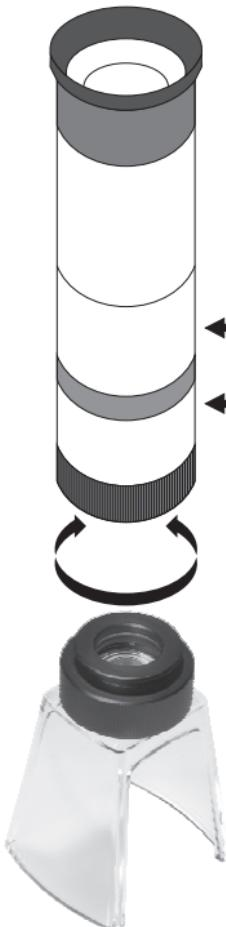
Jos haluat ripustaa kädessä pidettävän monokulaarin, pujota mukana tuleva kantohihna rungossa oleviin reikiin. Kun monokulaaria ei käytetä, aseta molemmat suojarat paikoilleen ja säilytä monokulaari mukana tulevassa kotelossa.
