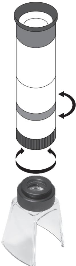
tywu do środka Do zastosowania jako stojący mikroskop należy wkręcić przednią część ręcznego monokularu i po stronie obiektywu przykręcić do monokularu stojącą lupę.
