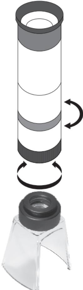
Per l'impiego come microscopio standard, inserire avvitando la parte anteriore del monoculare manuale e avvitare la lente d'ingrandimento lato obiettivo sul monoculare manuale.
