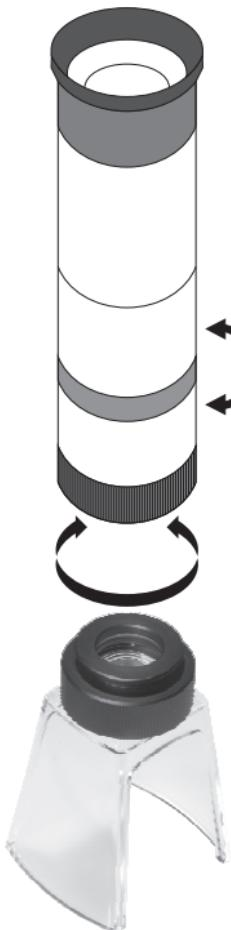
鏡のレンズ側を回して緩めてください。スタンド顕微鏡としてお使いいただくには、携帯型単眼鏡の前部をねじ込み、置き型ルーペのレンズ側を携帶用単眼鏡に取り付けてください。
