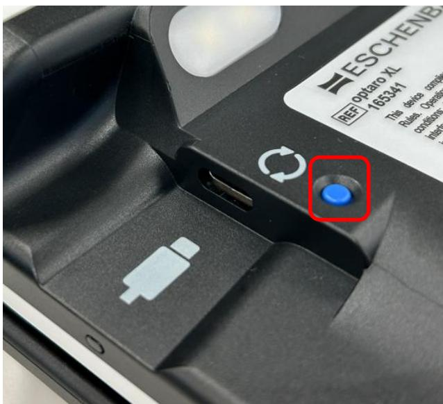
Solange die **LED-Verbindungsanzeige orange** leuchtet (oder blinkt) befindet sich optaro® XL im Updatemodus und kann nicht wie gewohnt verwendet werden. Wird optaro® XL während des Firmware-Updates ausgeschaltet oder der Reset-Button gedrückt, dann wird das Update abgebrochen und die alte Firmware wird weiterhin verwendet.
